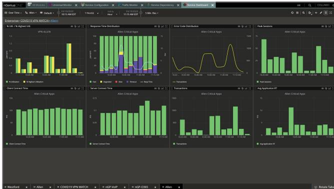
圖 2：nGeniusONE Service Dashboard 分析，可讓使用者透過單一窗格檢視錯誤代碼分布，以及降級和緩慢的反應時間。
